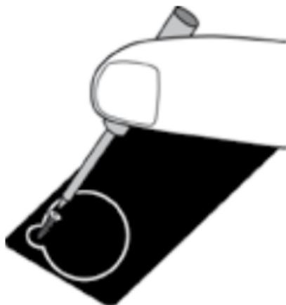
Zum Wechseln oder Einsetzen der Batterie, schrauben Sie den Batteriefachdeckel auf der Rückseite des Gerätes auf. Setzen Sie die Knopfzelle mit der Plus-Seite nach oben in die dafür vorgesehene Öffnung. Wenn Sie eine Batterie wechseln, bietet es sich an, die verbrauchte Batterie mit dem Schraubenzieher leicht aus der Öffnung zu heben. Setzen Sie danach den Batteriefachdeckel wieder auf das Gerät und schrauben Sie ihn wieder zu.
